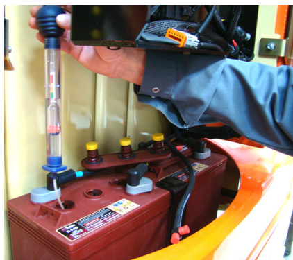
Figura 5-8. Măsurarea densității specifice a electrolitului
